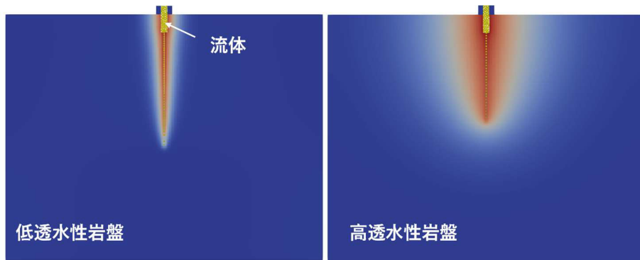
図4 岩盤透水性を考慮した水圧分布の比較（左：低透水性、右：高透水性）
