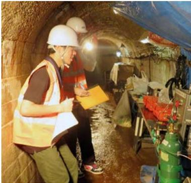
私が所属する地殻開発工学分野(石田研)は、主に岩盤の破壊や安定性を研究対象としています。私は、水圧破碎の現場実験を行い、その際に発生する微小破壊を測定・解析する、という研究を行っています。
